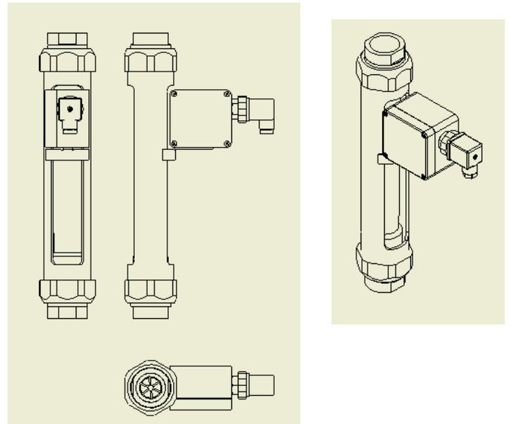
Figure 11 Fixation du contact K33 sur Tubux M30
