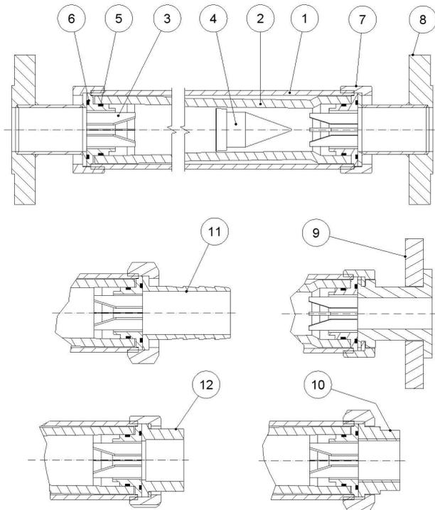
Figure 3 Schéma en coupe FVA Tubux M30
