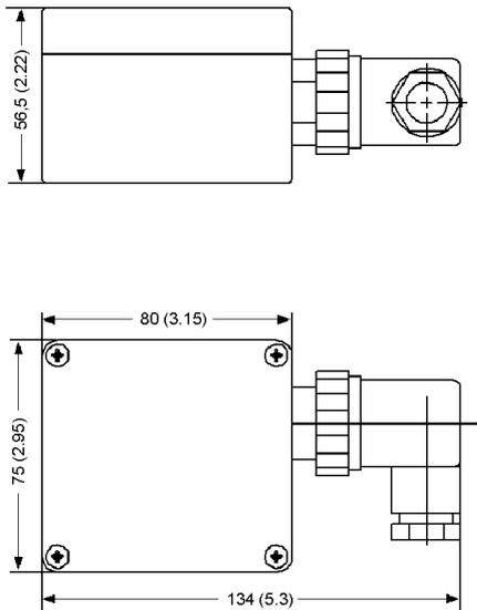
Figure 9 Changeur K33, cotes en mm (pouces)
