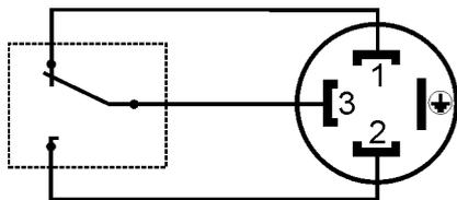
Figure 10 Raccordement électrique K33
