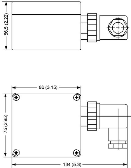
Figure 12 Contact inductif K33i, cotes en mm (pouces)
