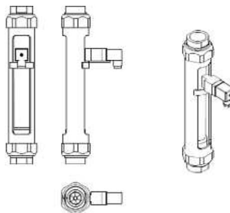
Figure 8 Fixation du contact K17 sur Tubux M30
