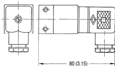
Figure 5 Contact K17, cotes en mm (pouces)
