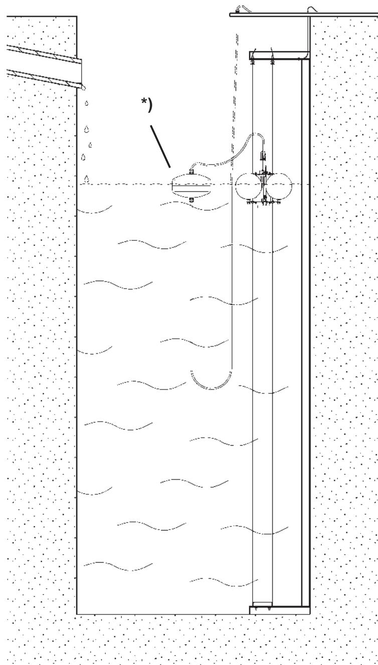
\*) Flotteur auxiliaire, Ø env. 165 mm x env. 120 mm, en acier inox 316 Ti
